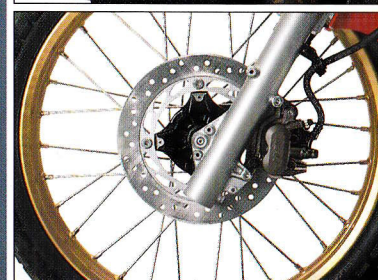
Ultra-stabile Vorderradgabel (41 mm Ø) Leichte Vorderrad-Scheiben- bremse mit Doppelkolben- bremszange Die Aluminiumfelgen verdanken ihre optimale Stabilität den tangential angeordneten Spei- chen. Der Maßstab in ihrer Klasse.
