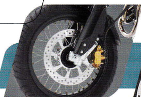
Griffige Reifen auf breiten schwarz eloxierten Alufelgen mit Drahtspeichen, wirkungsvoll verzögert von großen Scheibenbremsen.
