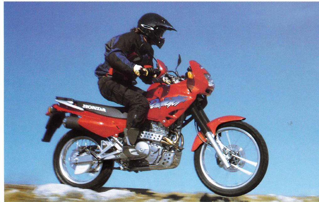
arbeit. Das Vorderrad ist mit einer 256-mm-Ø-Einscheibenbremse mit Doppelkolbenbremszange, das Hinterrad mit einer robust geschützten 220-mm-Ø-Einscheibenbremse ausgestattet. Vorne bietet das Schutzblech mit integrierter Gabelbrücke zusätzliche Stabilität, und auch die Gabelrohre sind über die gesamte Länge verkleidet. Die tangentiale
